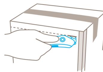
Mit der Messernase **stechen** Sie ins Schneidmaterial ein. **Nicht** hebeln in verstärkten Kartonecken und an Metallklammern!
