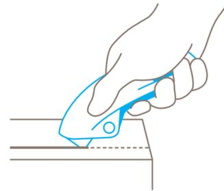
Um die **Klinge auszulösen**, Sicherung entriegeln und Hebel betätigen. Jetzt können Sie schneiden.
