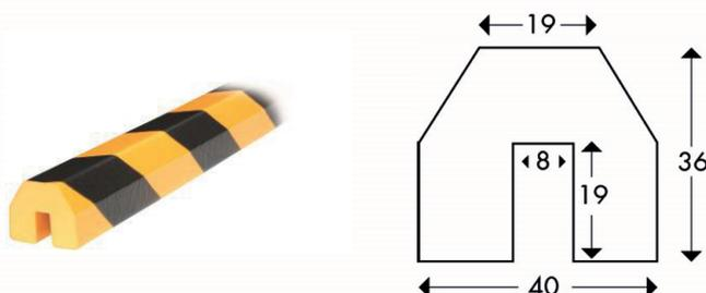
Kantenschutz Typ BB gehört zu den Warn- und Schutzprofilen mit dem charakteristischen Namen Knuffi®, die fungiert als persönliche Knautschzone für Menschen, Maschinen und auch Inventar, absorbiert harte Stöße und verhindert so wirksam Verletzungen oder Sachschäden.
