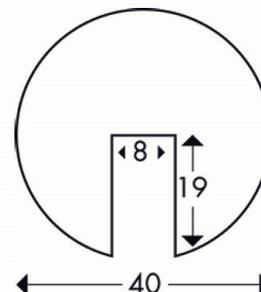
Kantenschutz Typ B gehört zu den Warn- und Schutzprofilen mit dem charakteristischen Namen Knuffi®, die fungiert als persönliche Knautschzone für Menschen, Maschinen und auch Inventar, absorbiert harte Stöße und verhindert so wirksam Verletzungen oder Sachschäden.
