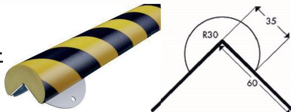
Das Wall Protection Kit kann durch seinen Edelstahlrücken an unterschiedlichen Untergründen angeschraubt und somit vielseitig eingesetzt werden. Gleichzeitig absorbiert der flexible Polyurethanschaum durch seine elastische Beschaffenheit selbst härteste Stöße und warnt durch die Warnmarkierung vor Gefahrenquellen an Kanten, Vorsprüngen und Hindernissen.
