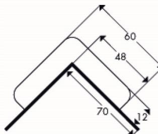
Das Wall Protection Kit kann durch seinen Edelstahlrücken an unterschiedlichen Untergründen angeschraubt und somit vielseitig eingesetzt werden. Gleichzeitig absorbiert der flexible Polyurethanschaum durch seine elastische Beschaffenheit selbst härteste Stöße und warnt durch die Warnmarkierung vor Gefahrenquellen an Kanten, Vorsprüngen und Hindernissen.
